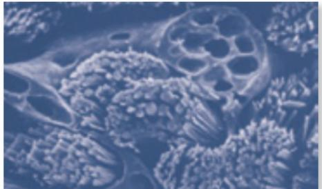
Auch bei den gewebten oder gewirkten Mikrofaserstoffen kann sich bei Gebrauch eine Pillingbildung einstellen. Die Pills bestehen jedoch hauptsächlich aus Fremdfasern (Kleidung) und können auch hier mit einem Fusselrasierer entfernt werden.
